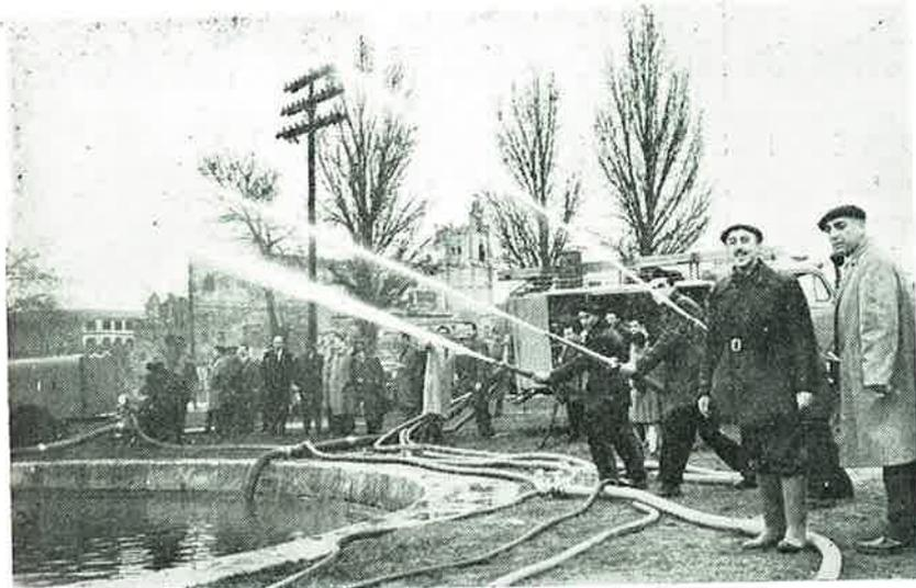
refrigera por aire, con una capacidad de 1.000 litros por minuto, con lanzamiento de agua a 80 metros de altura. Esta motobomba se suministra con carro remolque, enganchándose a vehículos automóviles, y sirve también de almacén transportador de todos los elementos que la motobomba puede necesitar.
